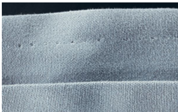
Abb. 2: Gewebefadenverdrängung durch die Nähadel Es wurde ohne Nähfaden genäht. Von links nach rechts: Nadel NM 70 (10), NM 80 (12), NM 90 (14), NM 100 (16).
